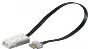
а) Датчик наклона
