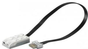
а) Датчик наклона
