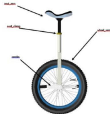
Рисунок 1. Приспособ. для крепления седла к стволу.
